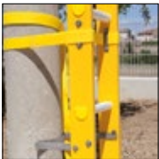
Sistema de apoyo y amarre
